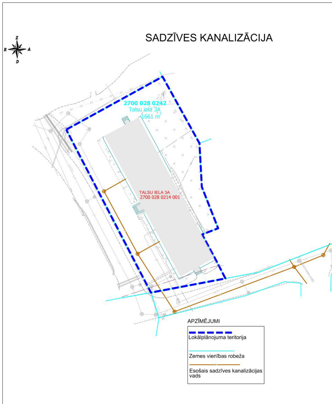
8.5.1.att. Esošais sadzīves kanalizācijas vads (pieslēgumi pie ēkas) Talsu ielā 3A
